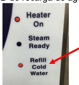
*Sonará una alarma y el vapor dejará de salir a través de la boquilla de la manguera cuando se presione el interruptor de vapor en el mango. Las bombas no funcionarán cuando el depósito de agua esté vacío.*
