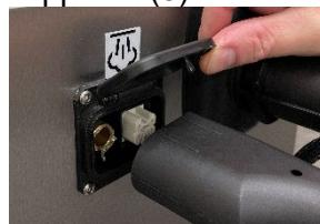
Vérifiez qu'il est correctement fixé et que la goupille du clapet est engagée dans le trou du tuyau.
