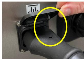
确保蒸汽管无法拔出。
