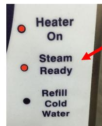
*Vuelva a permitir que aumente la temperatura y el indicador luminoso del vapor se volverá a iluminar (14)*
