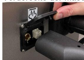
Stellen Sie sicher, dass er bis zum Anschlag eingeschoben wird und der Stift an der Klappe in das Loch am Schlauch einrastet.
