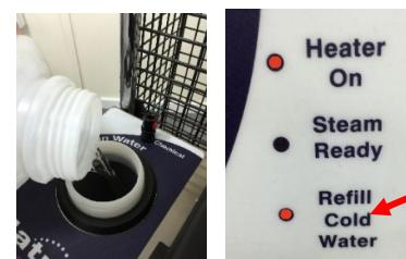
При нажатии выключателя подачи пара на ручке раздается звуковой сигнал, и пар больше не будет выходить из форсунки. Насосы не будут работать, когда бак для холодной воды пуст.
