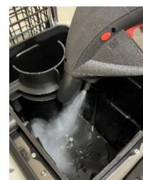
Volte a esperar que a temperatura aumente e que o indicador luminoso de vapor se volte a iluminar (14)
