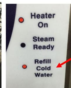
*Quando viene premuto l'interruttore del vapore sull'impugnatura verrà emesso un segnale acustico e il vapore non uscirà più dall'ugello. Le pompe non funzioneranno se il serbatoio dell'acqua fredda è vuoto.*
