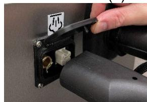
Accertarsi che sia completamente inserito e che il perno sulla linguetta si blocchi nel foro sul tubo.
