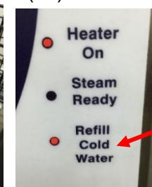
*Irá soar um alarme e o vapor deixará de sair do bocal quando o interruptor de vapor na pega for premido.*
