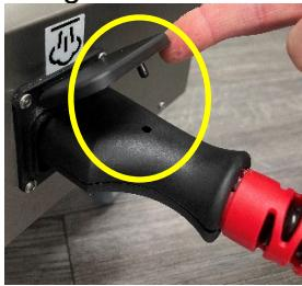
*Forsikre deg om at dampslangen ikke kan trekkes ut.*
