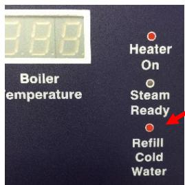
在按下手柄上的蒸汽开关时，会有蜂鸣器响起，蒸汽不再从喷嘴中喷出。
