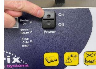
Il LED di accensione del riscaldatore (Heater On) (7) si illuminerà.
