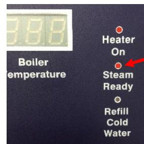
Låt temperaturen öka igen tills LED-lampen ånga redo att användas tänds igen (9)
