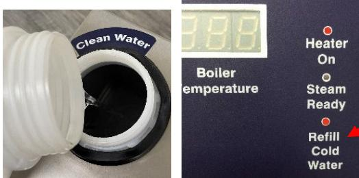
*Quando viene premuto l'interruttore del vapore sull'impugnatura verrà emesso un segnale acustico e il vapore non uscirà più dall'ugello. Le pompe non funzioneranno se il serbatoio dell'acqua fredda è vuoto.*
