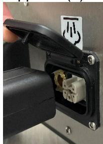
Vérifiez qu'il est correctement fixé et que la goupille du clapet est engagée dans le trou du tuyau.
