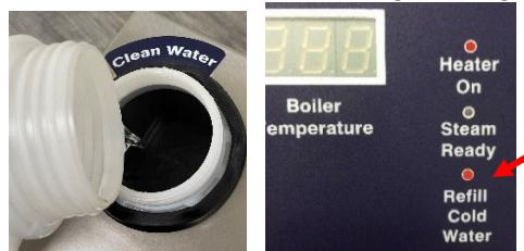
Sonará una alarma y el vapor dejará de salir a través de la boquilla de la manguera cuando se presione el interruptor de vapor en el mango. Las bombas no funcionarán cuando el depósito de agua esté vacío.
