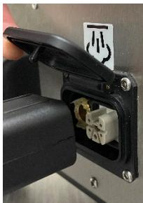
Stellen Sie sicher, dass er bis zum Anschlag eingeschoben wird und der Stift an der Klappe in das Loch am Schlauch einrastet.
