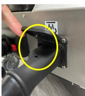
确保蒸汽管无法拔出。
