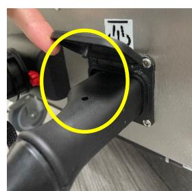
Stellen Sie sicher, dass der Dampfschlauch nicht herausgezogen werden kann.
