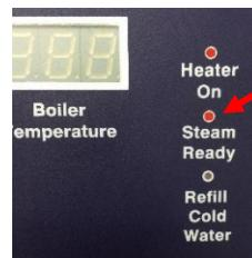
Wenn die LED-Anzeige 'Dampf bereit' (12) aufleuchtet, kann die Maschine verwendet werden.
