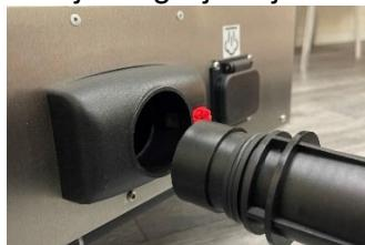
*Als de slang beschadigd raakt, moet de hele slang worden vervangen. Probeer deze taak niet zelf uit te voeren, maar neem contact op met een door Matrix goedgekeurde leverancier voor vervanging.*
