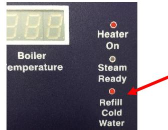
Quando viene premuto l'interruttore del vapore sull'impugnatura verrà emesso un segnale acustico e il vapore non uscirà più dall'ugello. Le pompe non funzioneranno se il serbatoio dell'acqua fredda è vuoto.
