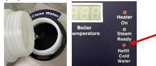
При нажатии выключателя подачи пара на ручке раздастся звуковой сигнал, и пар больше не будет выходить из форсунки. Насосы не будут работать, когда бак для холодной воды пуст.
