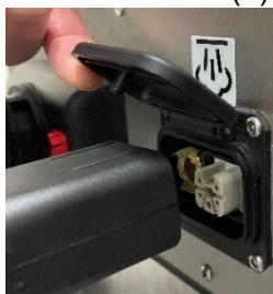
Accertarsi che sia completamente inserito e che il perno sulla linguetta si blocchi nel foro sul tubo.
