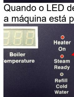
Quando o LED de vapor pronto (12) se iluminar, a máquina está pronta a ser utilizada.
