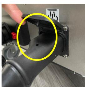
*Stellen Sie sicher, dass der Dampfschlauch nicht herausgezogen werden kann.*
