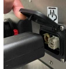
*Stellen Sie sicher, dass er bis zum Anschlag eingeschoben wird und der Stift an der Klappe in das Loch am Schlauch einrastet.*
