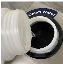
*Использование любой жидкости, кроме чистой холодной воды в баке для воды, аннулирует гарантию изготовителя.*
