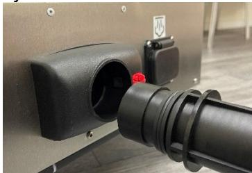
*Pokud dojde k poškození hadice, je nutné vyměnit celou hadici. Nepokoušejte se o tento úkol sami, s žádostí o provedení výměny se obrátte na dodavatele schváleného společnosti Matrix.*
