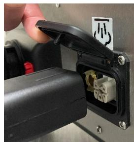
确保将其全部插入，并将盖板上的销钉锁入软管上的孔中。
