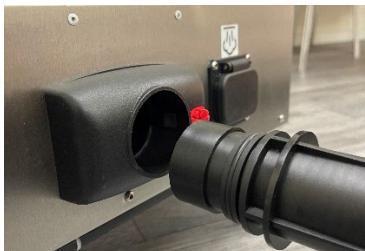
*Hvis slangen bliver beskadiget, skal hele slangen udskiftes. Forsøg ikke at selv at gøre dette. Kontakt en leverandør, der er godkendt af Matrix, for udskiftnings.*
