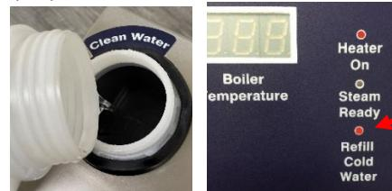
При нажатии выключателя подачи пара на ручке раздастся звуковой сигнал, и пар больше не будет выходить из форсунки. Насосы не будут работать, когда бак для холодной воды пуст.
